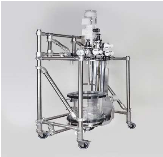
Schritt 3: Abgesenkte Position, optional schwenkbar unter Rührer, arretiert und kipp sicher
