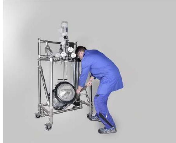
Schritt 6: Vollständiger Kippvorgang durch Lösen der Arretierung
