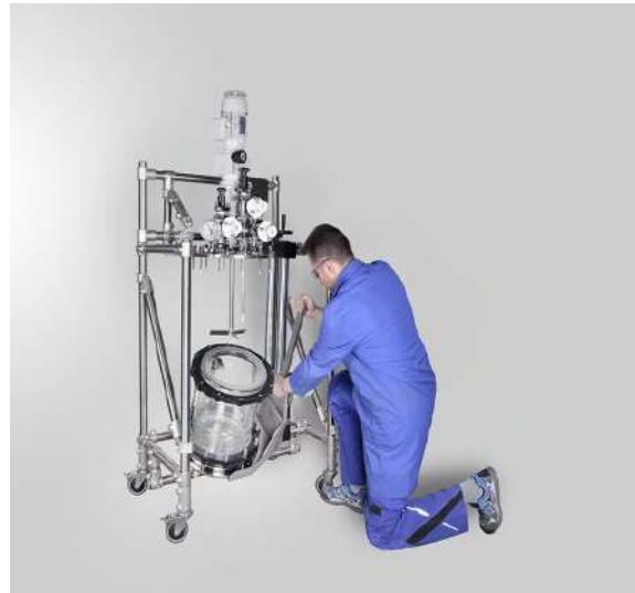
Schritt 4: Kippvorgang durch Lösen der Arretierung
