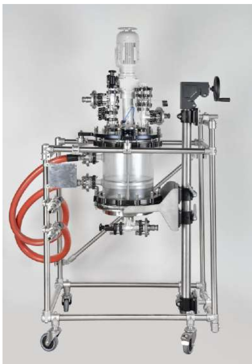
Schritt 1: Grundstellung mit Deckelplatte auf Bedienhöhe
