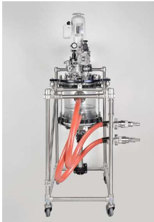
Schritt 2: Adapteranschluß für Produkt und Temperiermedien
