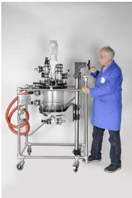
Schritt 3: Absenken Kompletteinheit für Handlochbefüllung
